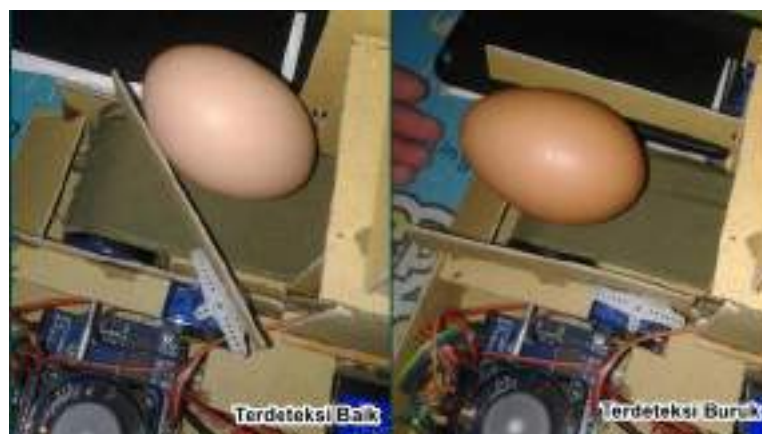
Gambar 4.26 Pergerakan palang penyortiran telur baik dan telur buruk
